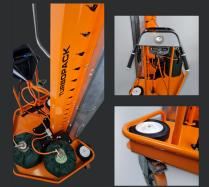
Es befinden sich Sicherheitsventile an jeder Gasflasche zur Erkennung von Schlauchbrüchen und Führungsräder am Schrumpfmobil vermeiden einen direkten Kontakt mit dem einzuschrumpfenden Objekt.
