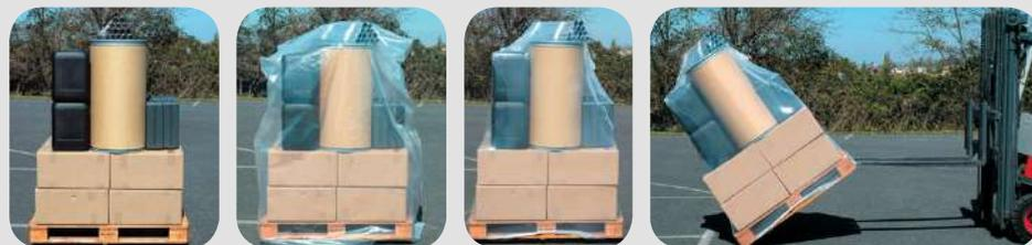
Le film se rétracte sous la chaleur produite par RIPACK® SERIES 3000 en épousant la forme du produit. Le film forme ainsi une excellente protection et une barrière thermique. Les objets sont maintenus solidairement et la chaleur transmise est très faible et sans incidence.
