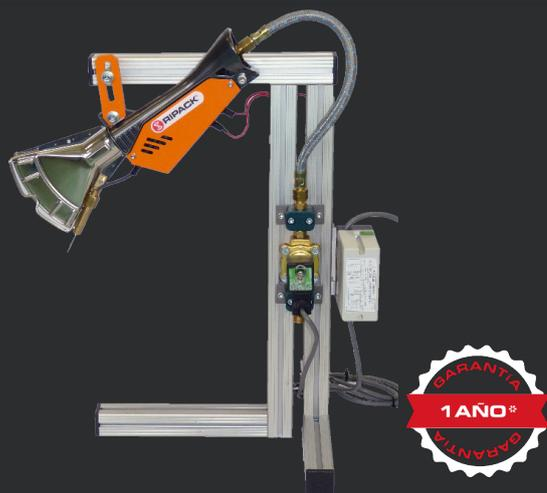
El Ripaflam se utiliza cuando se requiere un calor elevado inmediato y regulable de forma continua o alterna (flameado, calentamiento o secado de diversas piezas antes del tratamiento o la pintura, desbarbado de piezas de plástico, retractilado de películas de plástico, desplumado de aves de corral...etc).
